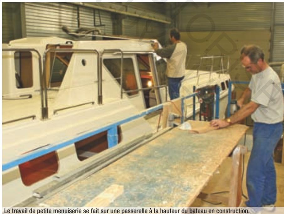
Le travail de petite menuiserie se fait sur une passerelle à la hauteur du bateau en construction.
